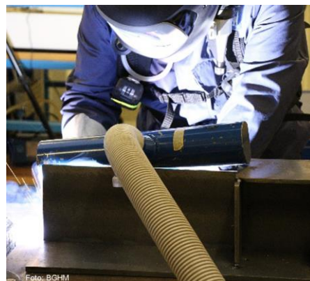
„Punktabsaugung“ mit HV Absaugung
