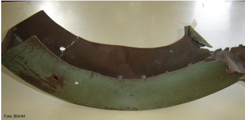
Rotationsvisier nach Beaufschlagung durch zerplatzte Schleifscheibe
