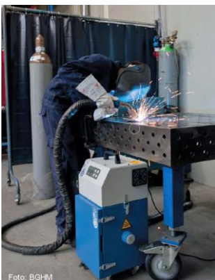
„Brennerintegrierte Absaugung“ mit mobiler HV Absaugung
